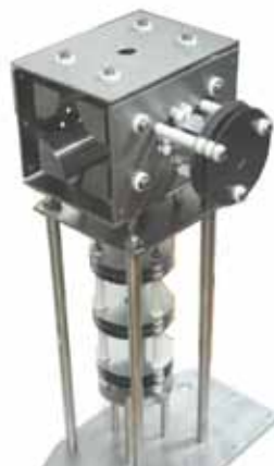
光電効果を用いた低エネルギー電子銃。光電陰極にLaB6単結晶、光源に半導体レーザーを用いることにより、エネルギー分析器を使わずに0.15eV程度のエネルギー分解能の実験が可能となる。
