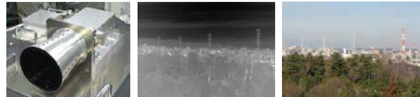
図1. 金星探査機搭載赤外カメラ (左) で撮られた赤外画像 (中) と同じ場所を市販デジカメで撮影した画像の比較 (右)。赤外画像では温度が高いところが白く、低いところが黒く写ります。赤外カメラは金星の雲を観測し、上層大気の風や温度分布を得ます。
