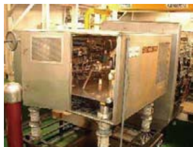
Cockcroft-Walton 型 荷電粒子加速装置 イオン源と高圧ターミナル
