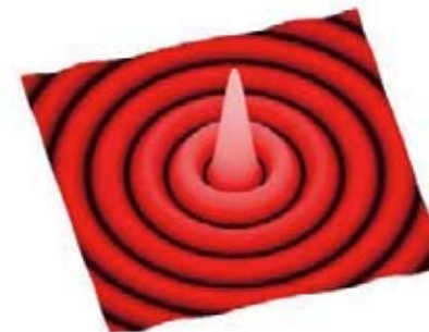
図: Java Applet で計算した X 線望遠鏡の撮像素子位置における X 線の観測強度分布。(出典) http://www2.rikkyo.ac.jp/web/izumoto/Phys_exp/phys_exp12.html
